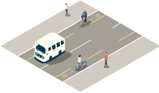
Radstreifen auf Fahrbahn
