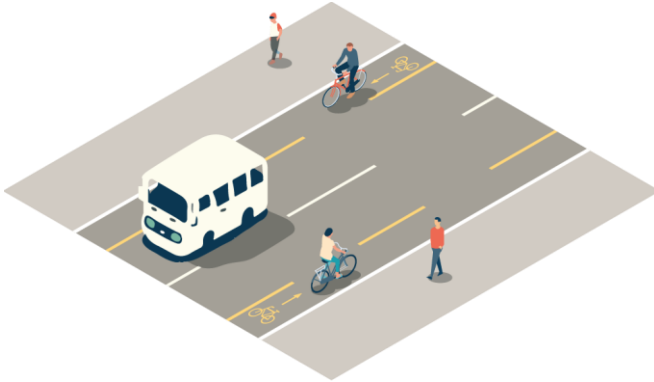
Radstreifen auf Fahrbahn
