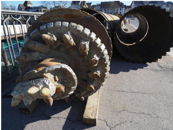
Drehbohrkopf für das Drehbohrgerät zur Erstellung der bis zu 22 Meter tiefen Bohrfähle ab Fahrbahnoberfläche
