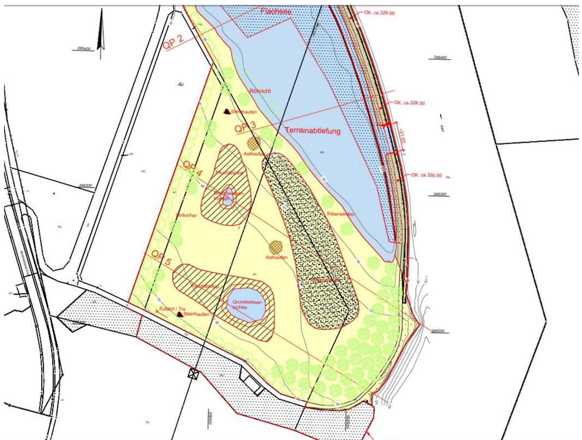
Abb. 4.3 Planausschnitt der öEAM «Wildtierwarteraum Grossmatt/Au». Am oberen Rand des Planausschnittes ist ein Teil der öEAM «Flachsee Grossmatt/Au» ersichtlich.
