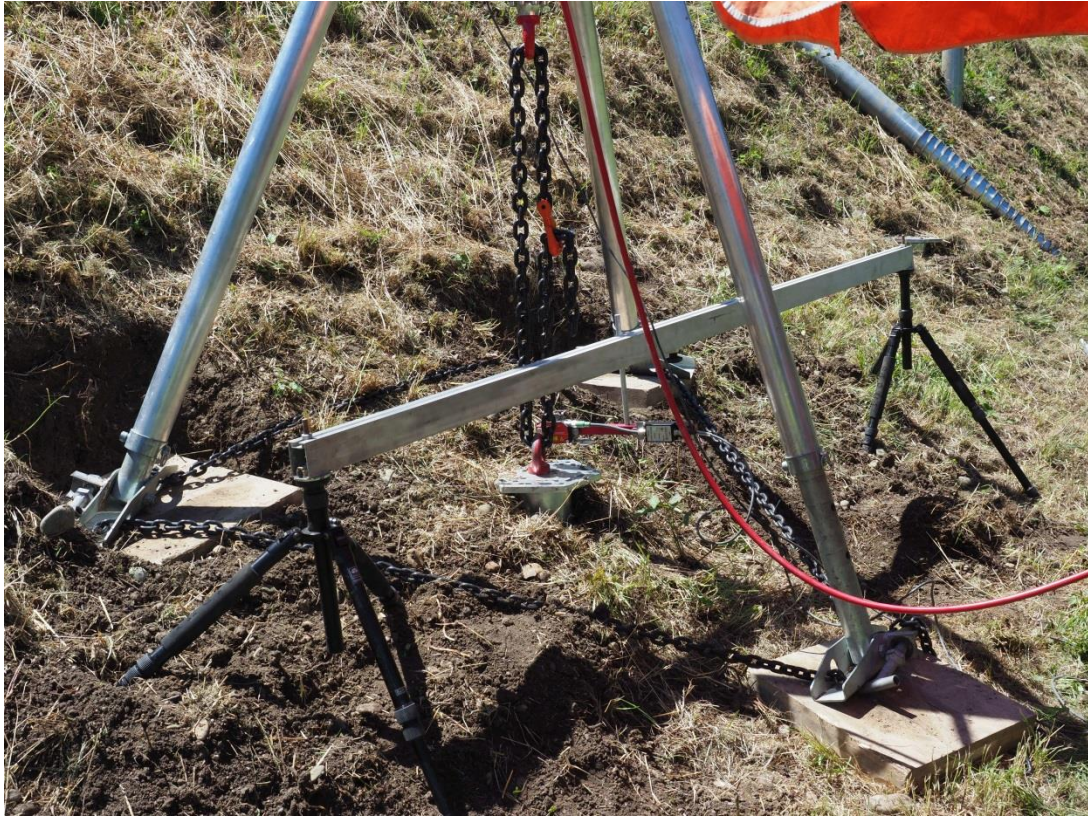
Abbildung 2: Versuchsaufbau für Zugprüfung
