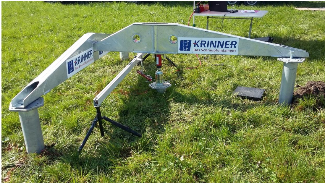
Abbildung 1: Versuchsaufbau für Druckprüfung mit Traverse und Zugverankerung
