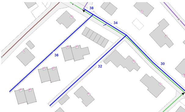
Die Nummerierung (Ordnung) beginnt mit zehn und läuft in Zehnerschritten weiter. In der Nachführung (in Blau dargestellt) können Zwischennummern vergeben werden, damit die einheitliche Nummerierung weiter eingehalten werden kann.
