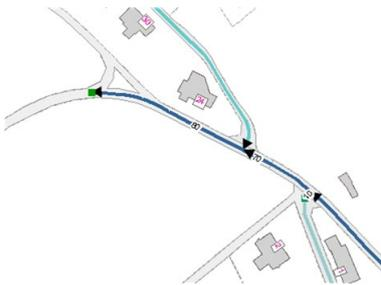
Strassenstücke ohne eindeutigen Abschluss, sind bis an die Bauzonengrenze zu definieren. Wenn die Definition der BB-Art 'Strasse\_Weg' kurz nach der Bauzone endet, so ist das Strassenstück bis an dieses Ende zu definieren.
