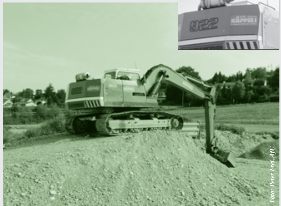
Diese Baumaschine ist mit einem Partikelfilter ausgerüstet.
