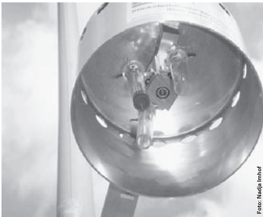
Messglocke mit Passivsammlerröhrchen
