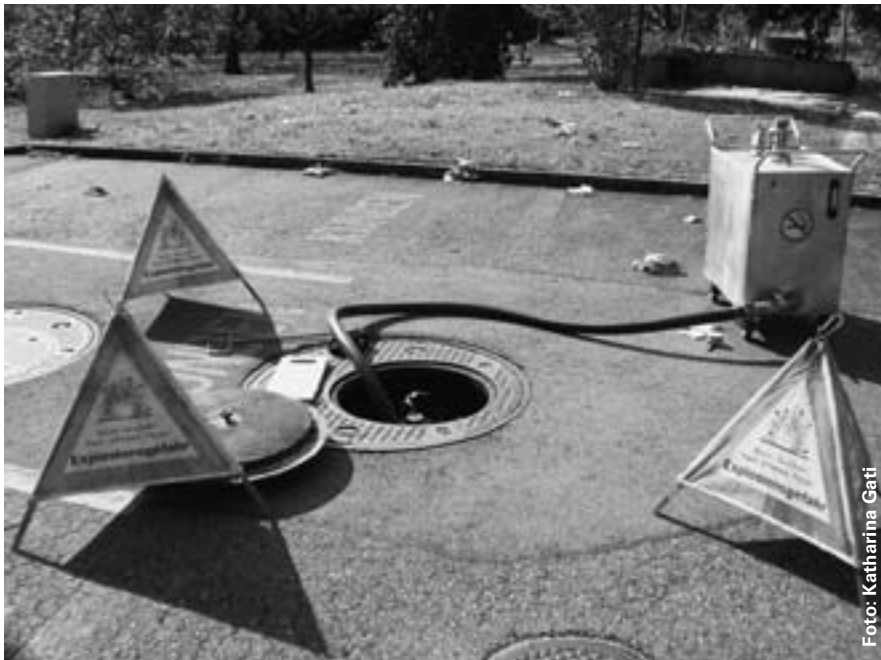
Nach jeder Stichprobenkontrolle wird das getankte Benzin in den entsprechenden Tank zurückgeleitet.
