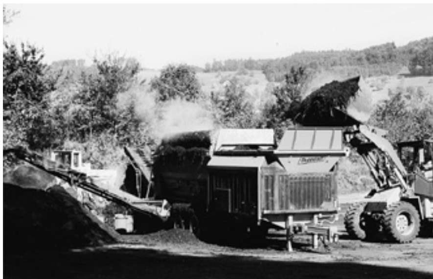
Der Kompost wird vor der Abgabe an die Landwirtschaft mit Hilfe einer Siebanlage von Grobbestandteilen befreit.
