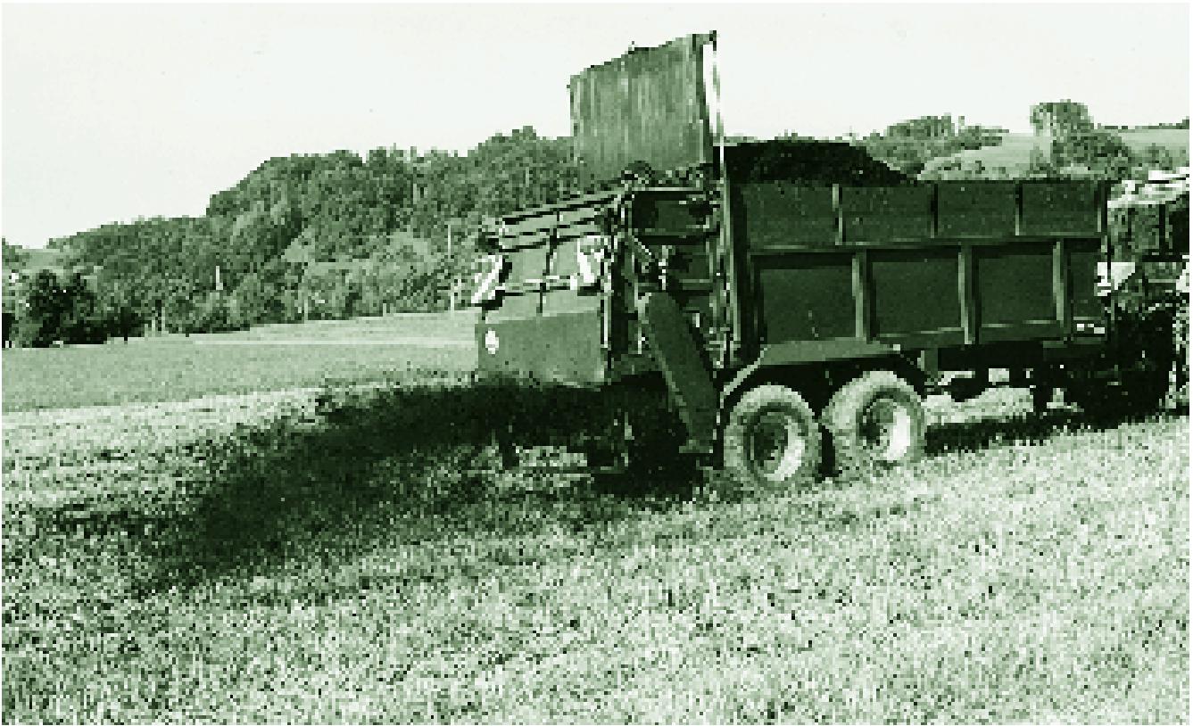
Spezialstreuer ermöglichen eine gleichmässige Verteilung des Kompostes auf den Feldern.
