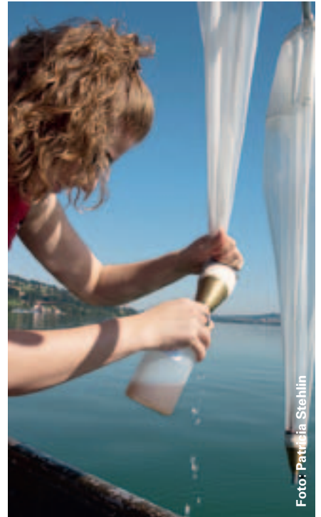
Das Zooplankton des Hallwilersees wird mit einem Netz, das vom Seegrund bis zur Oberfläche gezogen wird, angereichert und anschliessend untersucht.
