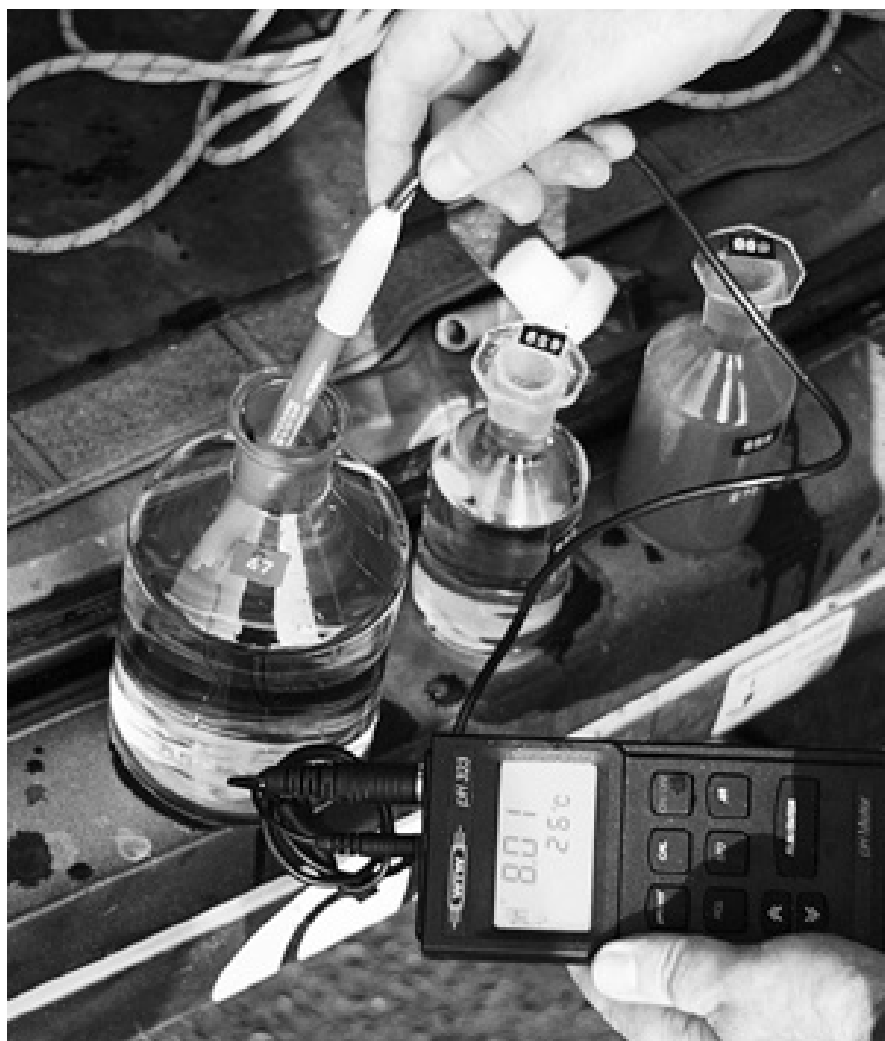
Die Temperatur sowie der pH-Wert des Wassers werden vor Ort bestimmt und der im Wasser gelöste Sauerstoff chemisch fixiert. Alle weiteren Untersuchungen der Wasserproben finden im Labor statt.
