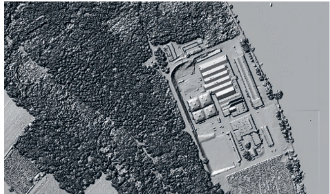
Aus LiDAR-Daten können verschiedene Rastermodelle abgeleitet werden. Links: digitales Geländemodell DTM (Hillshade) mit erkennbaren Waldstrassen und Rückegassen. Rechts: digitales Oberflächenmodell DOM (Hillshade) mit Wald, Feldern und Gebäuden Quellen: AGIS, AW
