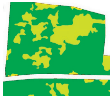
Bei der Ausscheidung von Jungwaldflächen kommen heute LiDAR-Daten zur Anwendung. Über das Vegetationshöhenraster können in drei Schritten Jungwaldflächen definiert werden. Links: klassiertes Vegetationshöhenraster. Mitte: räumliche Glättung des klassierten Rasters. Rechts: Jungwaldausscheidung (hellgrün: Jungwald, dunkelgrün: übriger Wald).
