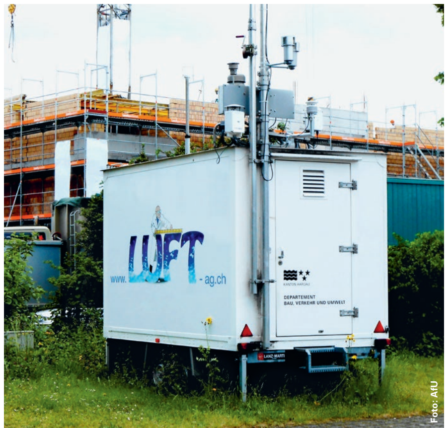
Messtation Suhr: Hier werden regelmässig die Konzentrationen von Feinstaub, Stickoxid und Ozon gemessen. Vergleichbare Messstationen unterhält der Kanton Aargau auch noch in Baden und Sisseln.
