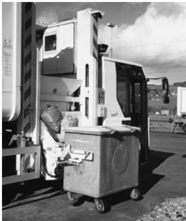
Mit dem Integralen Entsorgungssystem (IES) werden die Abfälle im kombinierten Transport Strasse/Schiene zur KVA transportiert. Der Sammelbehälter wird vom Fahrer des IES-Sammelfahrzeuges direkt auf die Bahn verladen. Das aufwändige Umladen und erneute Verpressen des Kehrichts entfällt.
