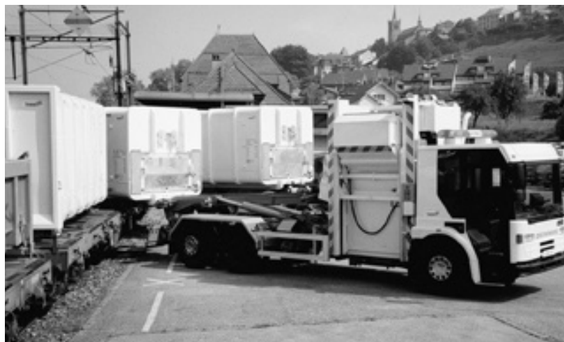
Mit dem Integralen Entsorgungssystem (IES) werden die Abfälle im kombinierten Transport Strasse/Schiene zur KVA transportiert. Der Sammelbehälter wird vom Fahrer des IES-Sammelfahrzeuges direkt auf die Bahn verladen. Das aufwändige Umladen und erneute Verpressen des Kehrichts entfällt.
