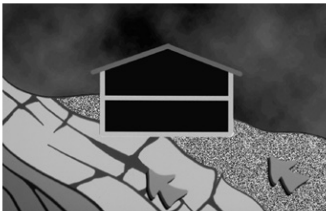
Abbildung 1: Das natürlich vorkommende Edelgas Radon wird in durchlässigen Böden leicht transportiert und steigt vom Bauuntergrund her auf.
