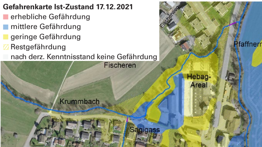
Gemäss der Gefahrenkarte Hochwasser (Stand Dezember 2021) weist das Hebag-Areal an der Gländstrasse in Vordemwald eine mittlere Gefährdung auf (Bildmitte blau). Quelle: AGIS
