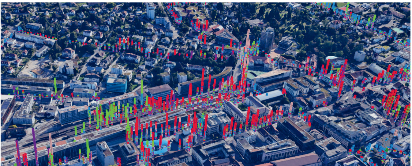
Ausschnitt der Messstrecke in Aarau vom 17. 7. 2024: Die gemessene elektrische Feldstärke wird in Google Earth als Balken dargestellt. Die verschiedenen Farben entsprechen den 35 vorkonfigurierten Frequenzbändern für Mobilfunk-, Rundfunk- und drahtlose Telekommunikationsdienste. Die Karte veranschaulicht die deutlich grössere Elektromog-Belastung am Bahnhof Aarau im Vergleich zu den Wohngebieten (je grösser der Balken, desto höher die gemessene Strahlung).
